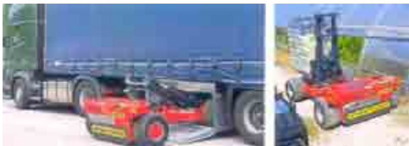
Prenosni rasklopivi viljuškar u transportnom i radnom položaju
