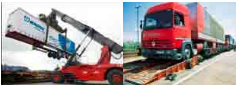
Huckepack tehnologija-Utovar drumskih vozila na železničke vagone
