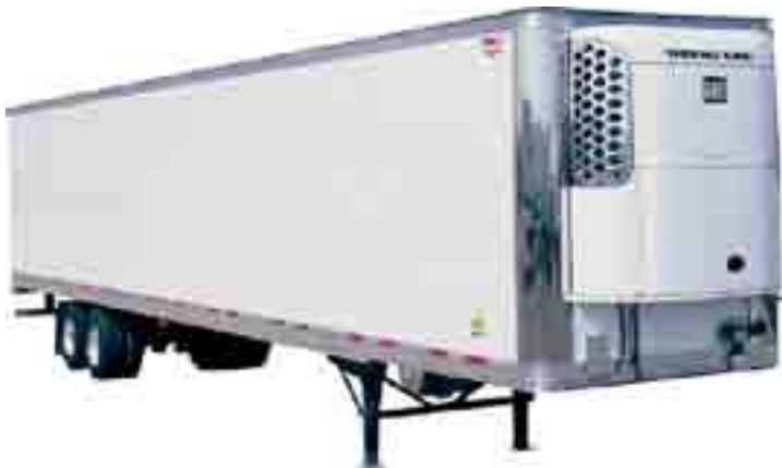
Rashladna jedinica – zadovoljava standarde ATP
