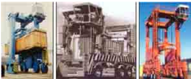
Opkoračivač vozila za vertikalno spuštanje i podizanje kontejnera
