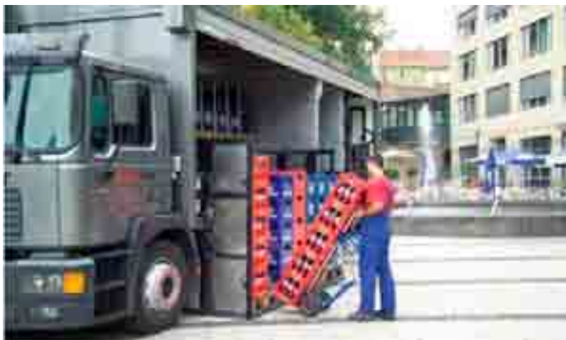
Hidraulična podizna platforma sa bočne strane
