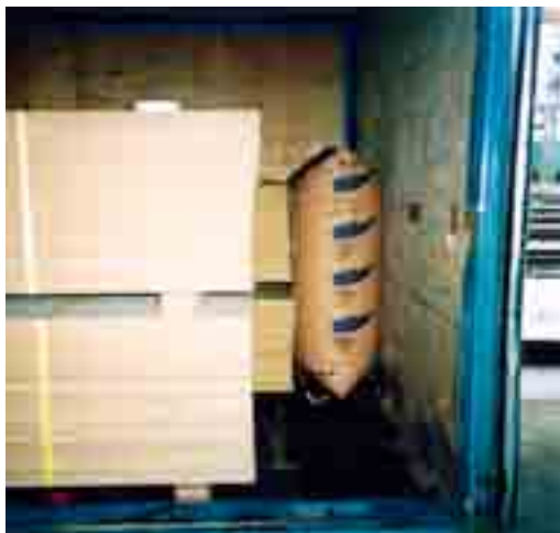
Slika 7. Obezbeđenje praznog prostora sa vrećama (naduavanje)
