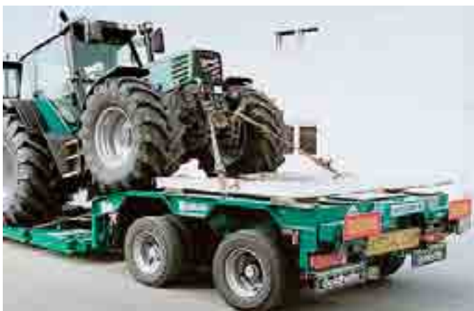
Sl. 60. Učvršćivanje tereta vezivanjem kajišima za poluprikolicu
