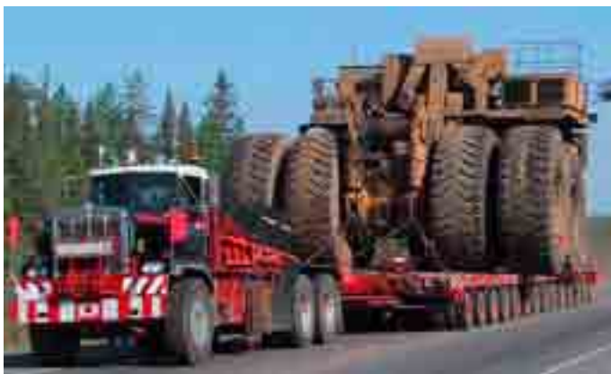
Sl. 59. Učvršćivanje tereta vezivanjem lancima i španerima za poluprikolicu
